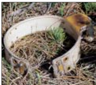
Halsbandet med radiosändare har en försvagningszon som går av efter ca 2 år.
